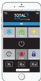
I modelli ACD200001 e ACD200003 sono collegabili tramite cavo RJ45 ( non compreso nella fornitura ) al router della rete dati locali. Prevista questa installazione la macchina diventerà visibile tramite WIFI tramite pc, tablet, cellulare. Connettendosi alla macchina, per esempio tramite cellulare, apparirà la seguente schermata:
