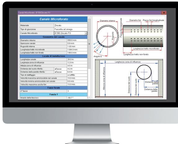
Il dimensionamento necessario per definire la struttura del tubo è possibile attraverso un sofisticato software di calcolo che permette di fornire un'accurata analisi del sistema di movimentazione dell'aria nell'ambiente.
