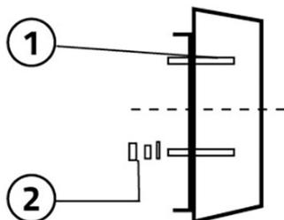
Bohren Sie ein Loch wie in der Anleitung angegeben, setzen Sie den Bolzen ein und zementieren Sie ihn ein.
