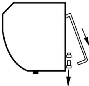
Schrauben Sie die Montageplatte ab und entfernen Sie sie
