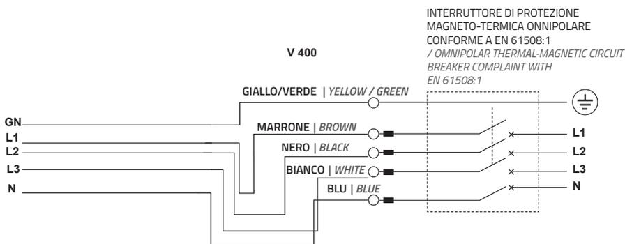
**NOTA:** è necessario collegare il disgiuntore termico, dei motori elettrici ad un sistema ausiliario di interruzione trifase esterno.
