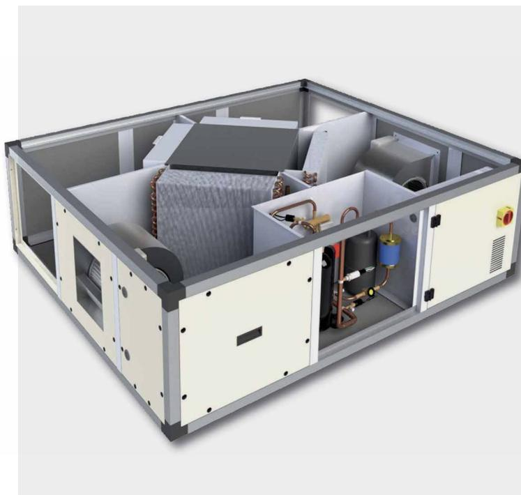
Le unità di rinnovo dell'aria **AIR DYN SYSTEM** sono caratterizzate dall'adozione di un doppio sistema di recupero dell'energia, altrimenti persa nella fase di espulsione dell'aria viziata: il primo, di tipo statico, mediante un recuperatore a flussi incrociati con piastre in alluminio, il secondo (in cascata al precedente), di tipo attivo, realizzato mediante circuito frigorifero reversibile.
