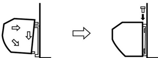
Installare la barriera d'aria sulla piastra di montaggio, accertandosi che si trovi in posizione di sicurezza e serrarla con le apposite viti.
