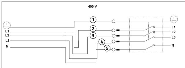
[L1 - L2 - L3] Collegare il conduttore di linea: internamente risultano inserite tutte le protezioni di sicurezza
