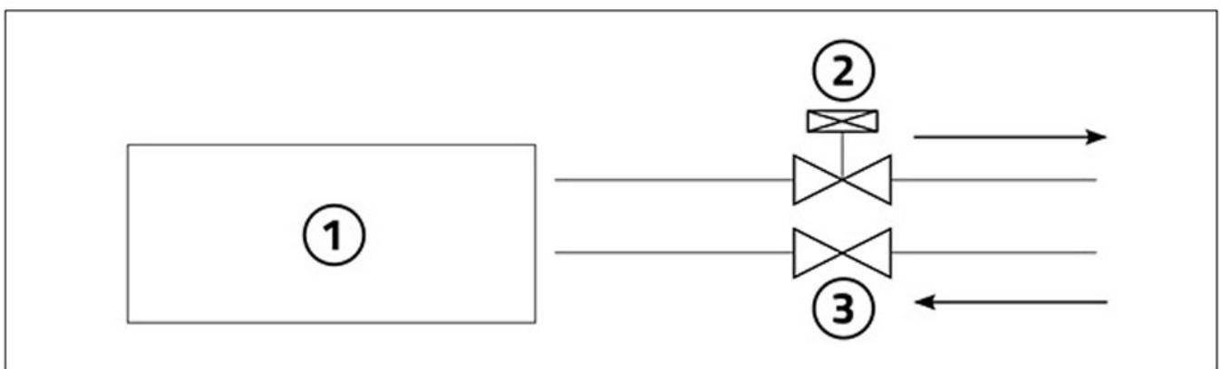
Raccorder le rideau d'air, en utilisant les raccords appropriés, au système d'eau.
