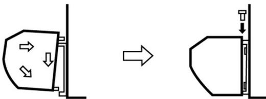
Bringen Sie den Luftschleier auf der Montageplatte an und stellen Sie sicher, dass er fest sitzt, indem Sie ihn mit den mitgelieferten Schrauben festziehen.
