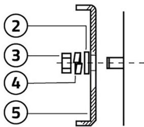
Bohren Sie ein Loch wie in der Anleitung angegeben, setzen Sie den Bolzen ein und sichern Sie ihn mit Zement.
