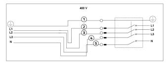
[L1 - L2 - L3] Connecter le conducteur de ligne : toutes les protections de sécurité sont insérées à l'intérieur
