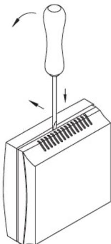
Pour ouvrir, insérer un tournevis (2.0) au milieu de la fente, appuyer vers le bas et soulever légèrement le cadre inférieur.
