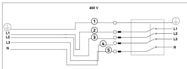
[L1 - L2 - L3] Connecter le conducteur de ligne : toutes les protections de sécurité sont insérées à l'intérieur
