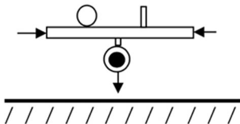
Pour assurer un bon fonctionnement et maintenir la longévité du Régulateur, il est recommandé de l'installer avec la sortie vers le bas.
