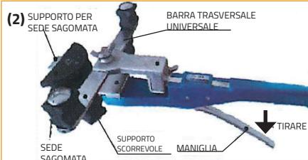
**Inserire la matrice di dimensioni corrette nel supporto per la sede sagomata, quindi posizionare la barra trasversale sul relativo supporto e serrare con la vite a farfalla.**
