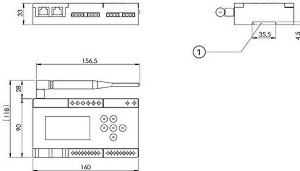
[1] DIN-Führungsanschluss IEC/EN 60715
