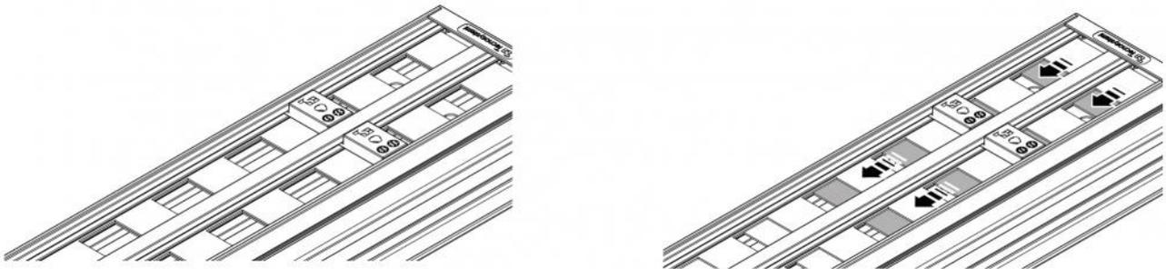
Den Schieber mit einem Schraubendreher von der Unterseite des montierten Diffusors einstellen.
