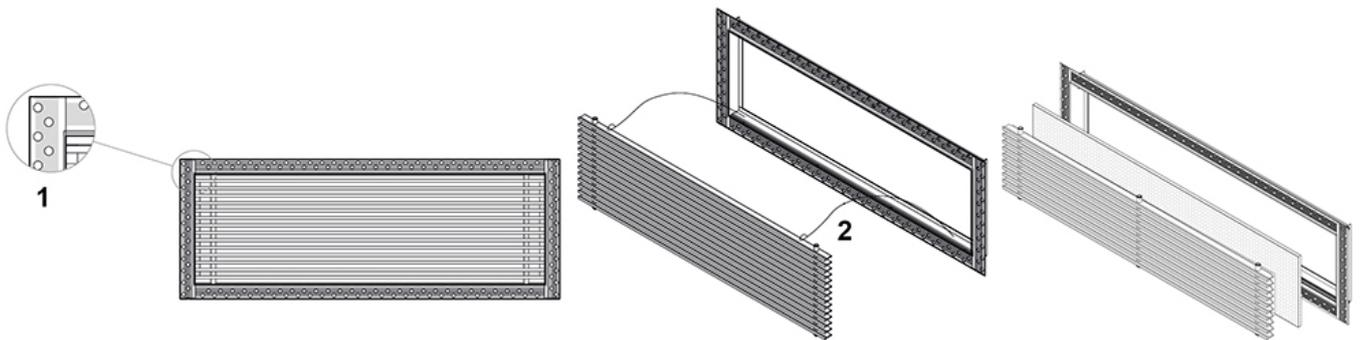
[1] Bohrungen im gesamten Rahmen zur Förderung der Adhäsion von zementhaltigen Verkleidungsmaterialien und zur Befestigung des Rahmens
