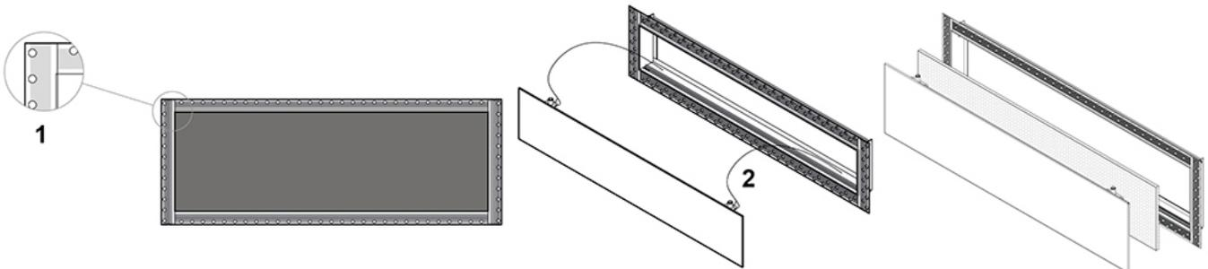
[1] Bohrungen im gesamten Rahmen zur Förderung der Adhäsion von zementhaltigen Verkleidungsmaterialien und zur Befestigung des Rahmens
