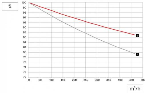
[A] Wirkungsgrad des Rückgewinners gemäß UNI1253/14: außen 7°C - innen 20°C (trocken)
