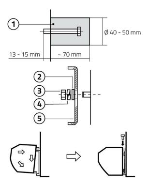
Bohren Sie ein Loch wie in der Anleitung angegeben, setzen Sie den Bolzen ein und sichern Sie ihn mit Zement.
