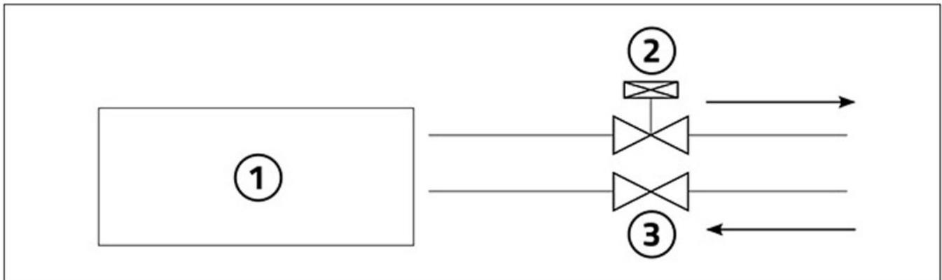
Schließen Sie die Barriere über die entsprechenden Anschlüsse an das Wassersystem an.
