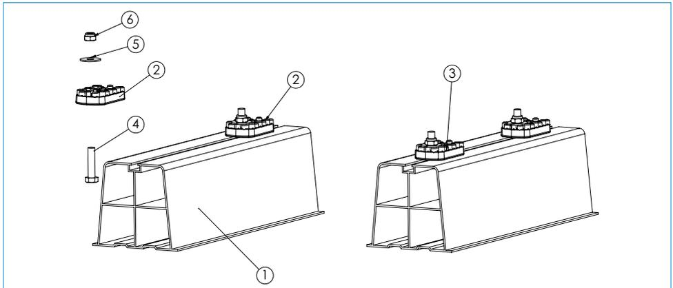
Posizionare il bullone (vedi particolare 4) nell'apposita feritoia della base a pavimento (vedi particolare 1). Fissare gli antivibranti "soft" sotto il supporto dell'unità esterna dove e' collocata la ventola, (vedi particolare 2 - antivibranti soft ), e gli antivibranti "hard" sotto il supporto dove e collocato il motore (vedi particolare 3 - antivibranti hard). Fissare l'unita' esterna tramite apposita viteria (vedi particolari 4;5;6) come raffigurato nel disegno.
