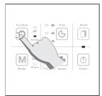
Premendo il tasto funzioni una volta si accende la spia del Ionizzatore Pressing the function key once turns on the Ionizer light
