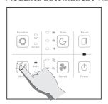
Quando si effettua l'accensione, la qualità dell'aria viene rilevata automaticamente. Scegliendo la modalità automatica, la ventola raggiungerà la velocità più idonea a seconda della qualità dell'aria rilevata.
