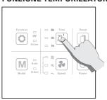
È possibile impostare il tempo di lavoro della macchina, operazione che si fa generalmente ad un alta velocità per il ricambio d'aria di una stanza.
