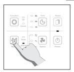
Premendo il tasto "Model" si può passare in modalità silenziosa e la macchina andrà al minimo per emettere il minor rumore possibile.
