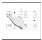
Premendo il tasto funzione due volte si attiva la lampada UV e la spia relativa. Premendo il tasto tre volte si accende sia la funzione ionizzatore sia la funzione UV.
