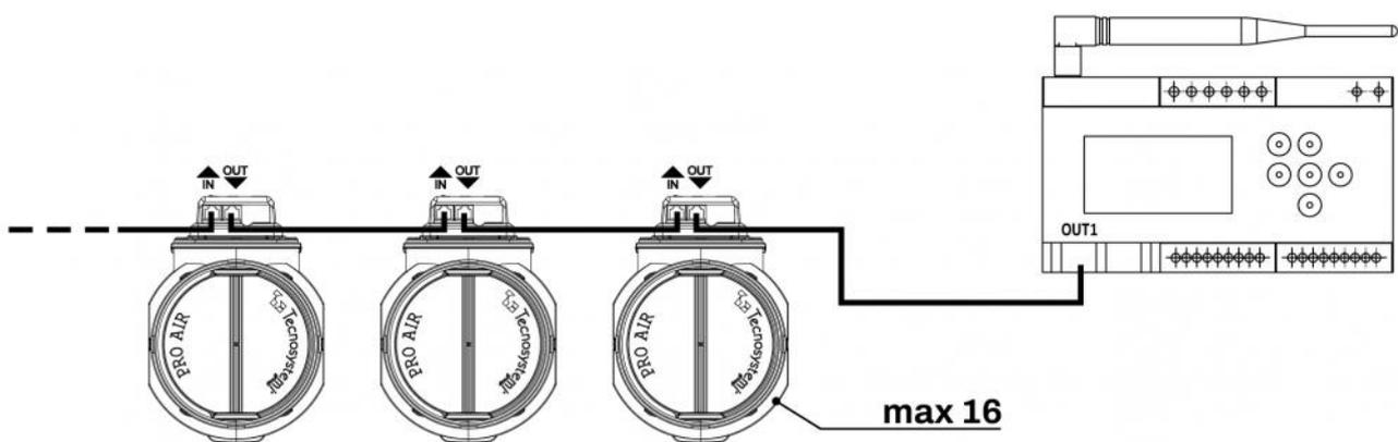
Il est possible de raccorder jusqu'à 16 registres motorisés en cascade.
