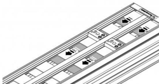
Régler le registre avec un tournevis sous le diffuseur monté.
