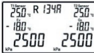
Lo strumento è in grado di calcolare il SH - Surriscaldamento e il SC - Sottoraffreddamento, come mostrato di seguito, a condizione che il refrigerante testato sia preimpostato e le sonde di temperatura con morsetto siano ben collegate.
