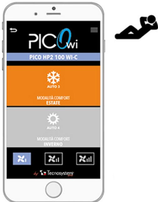
Il sistema, se impostato in modalità "Comfort Inverno" o "Comfort Estate", si attiva sfruttando la differenza di temperatura tra l'ambiente esterno e quello interno, al fine di raggiungere una temperatura interna ideale. È possibile scegliere tra le 3 velocità disponibili.
