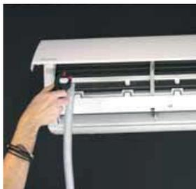
**4.** Attraverso l'utilizzo dell'apposita clip collegare il tubo flessibile da 3 metri nell'alloggiamento del filtro antipolvere.
