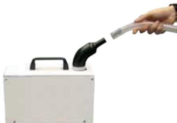
**3.** Appoggiare *Ultrasound Clean Machine* sul pavimento e collegare il tubo flessibile da 3 metri al tubo convogliatore d'uscita.
