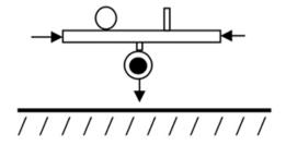
Per garantire il corretto funzionamento e mantenere la longevità Ad impianto terminato verificare l'assenza di fughe di Gas dai del Regolatore se ne consiglia l'installazione con l'uscita rivoltaverso il basso.
