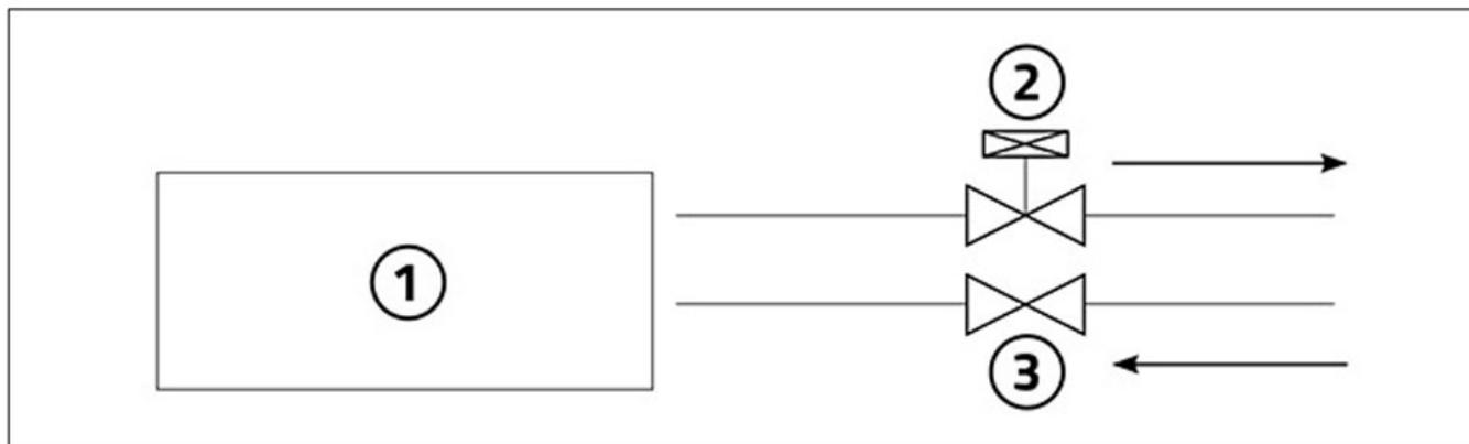
Collegare la barriera, tramite gli appositi attacchi, all'impianto dell'acqua.
