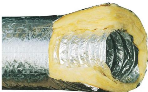
Il tubo canalizzato flessibile è rivestito esternamente da laminato in alluminio rinforzato e antivapore, mentre internamente il condotto è in laminato di alluminio e materassino isolante in fibra di vetro di spessore 25 mm e densità di 16 kg/m<sup>3</sup>.
