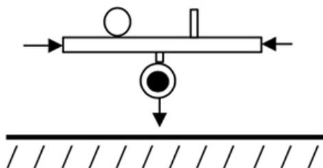
Per garantire il corretto funzionamento e mantenere la longevità del Regolatore se ne consiglia l'installazione con l'uscita rivolta verso il basso.
