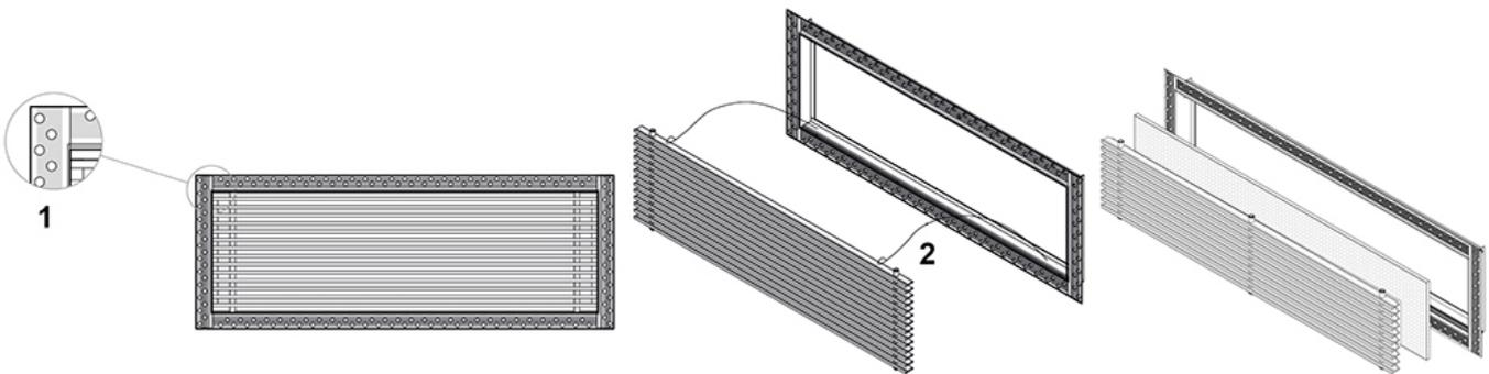
[1] Forature su tutta la cornice per favorire adesione materiali cementizi di mascheratura e per fissaggio del telaio
