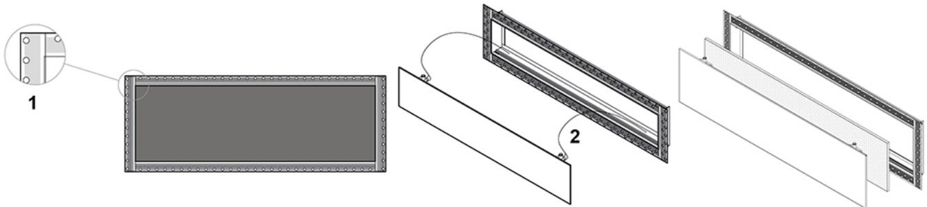
[1] Forature su tutta la cornice per favorire adesione materiali cementizi di mascheratura e per fissaggio del telaio
