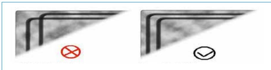
10. Se il cavo scaldante per porte esce attraverso la parete dell'unità refrigerante o del congelatore, occorre prestare attenzione per assicurarsi che non venga sepolto o incapsulato dalla schiuma o da qualsiasi altro tipo di isolamento. Ciò comporta scarso trasferimento di calore e potrebbe causare surriscaldamento ed eventuale guasto.
